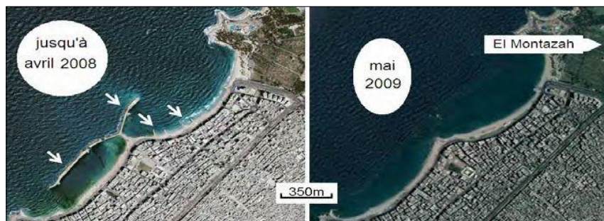
Fig. 20- Les grands travaux d'ingénierie récemment réalisés dans la partie nord-orientale de la côte d'Alexandrie ont, toutefois, eu le mérite de débarrasser la côte d'une partie des digues et épis (indiqués par des flèches ; image de gauche) qui l'accidentaient (images Google).
